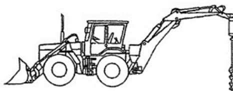
Esempio di terna con trivella
